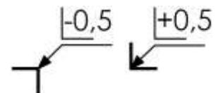
BB – Einpressdübel / Scheibendübel mit Zähnen einseitig
