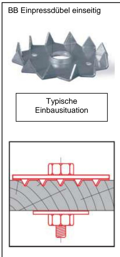
**BB – Einpressdübel einseitig** werden bei Verbindungen zwischen Holz und Stahl eingesetzt. Die Einpressdübel sind nach DIN 1052 verwendbar.
