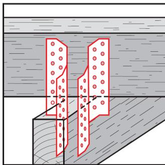
**BB – Sparrenpfettenanker rechts/links** können je nur auf einer Seite eingesetzt werden. Sie müssen daher immer zusammen verwendet werden. Es gibt sie in 5 verschiedenen Abmessungen, wobei die Typenbezeichnung der Gesamtlänge des Artikels entspricht. Die Zulassung ist für die Abmessungen 170, 210 und 250 mm beantragt.
