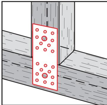
Die **BB – Flachverbinder** werden aus 2,5, bzw. 3,0 mm dickem Stahlblech hergestellt. Die Lochanzahl ist von der Abmessung abhängig.
