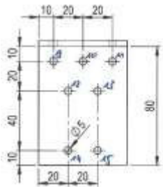
Abb. B. 61 Abmessungen des Winkelverbinders 618 166 40
