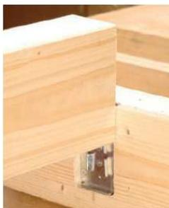
**BB – Balken Verbinder** werden aus verzinktem Stahlblech hergestellt. Es handelt sich hierbei um zweiteilige Holzverbinder ohne Schweißnähte, die mit Schrauben an den Holzbauteilen befestigt werden. Die Anzahl der Löcher ist von der Abmessung abhängig. Die in unterschiedlichen Größen hergestellten Verbinder werden zur verdeckten Verbindung von Hauptträgern und Nebenträgern an Stützen verwendet.
